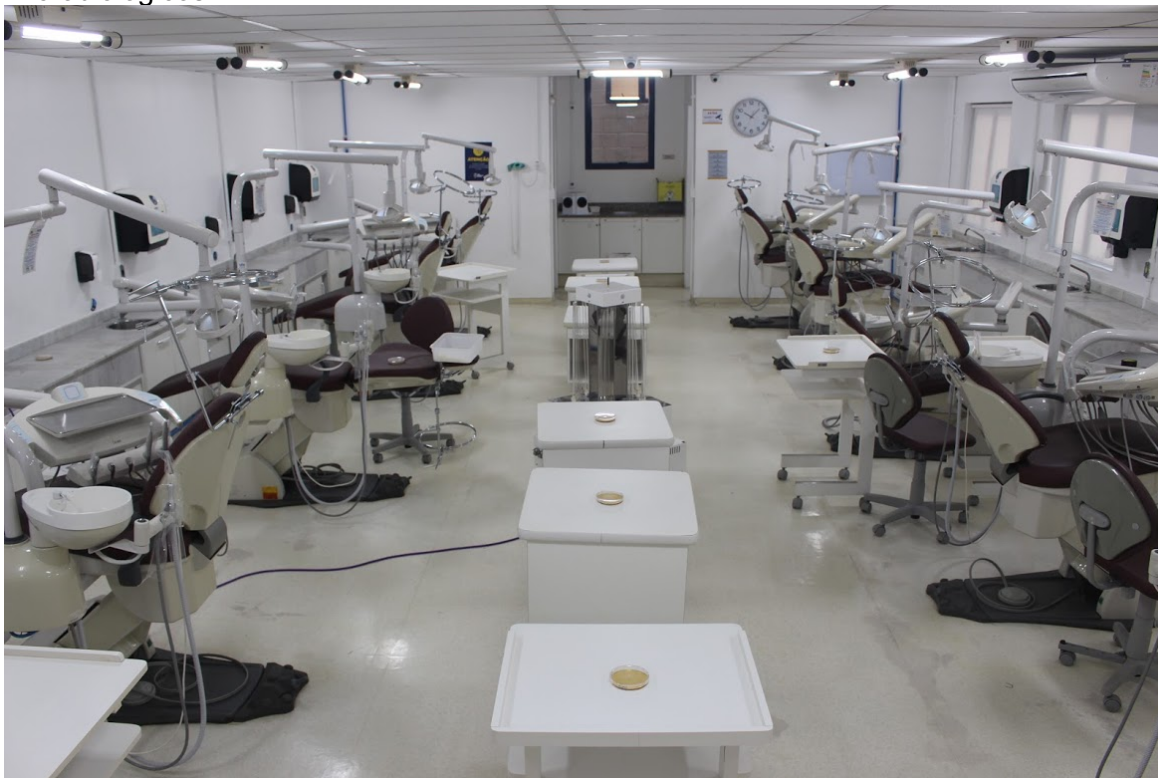
Figura 2 – Placas com ágar MRS distribuídas no ambiente clínico para os testes microbiológicos.
